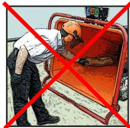
**IMMER** Niemals in den Einführtrichter hineinfassen oder Material per Hand nachstossen, verwenden Sie dazu Einen Stock falls Material nachgeschoben werden muss.
